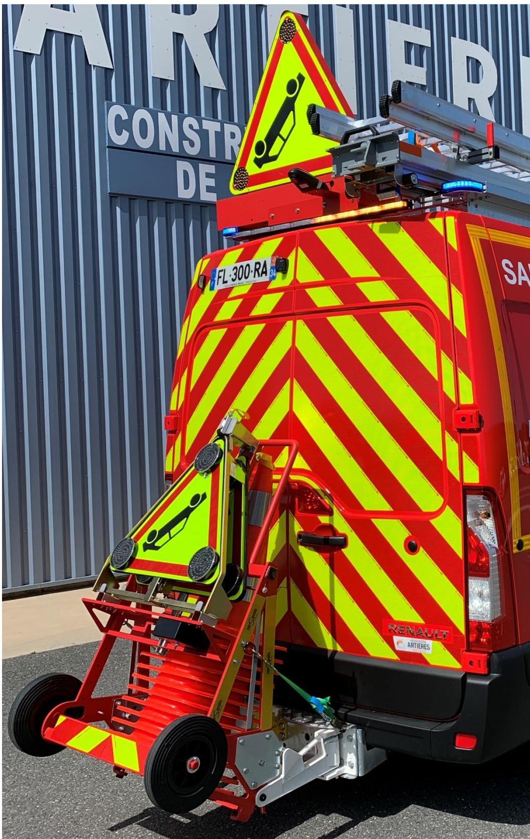
Chariot de balisage sur support Fourches Normalisées équipé d'un trilateral à déploiement automatique 700mm film classe 3 feux 120mm bicolore Orange/Bleu et d'un triangle fixe 700mm film classe 3 feux 120mm bicolore Orange/Bleu.
