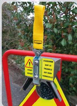
Verrouillage et déverrouillage rapide du triangle automatique via système de verrou à ressort.
