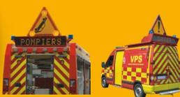
Triangle à LEDS caréné 1250 mm
