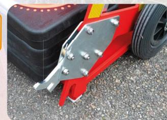
Verrouillage et déverrouillage rapide du triangle automatique via système de verrou à ressort.
