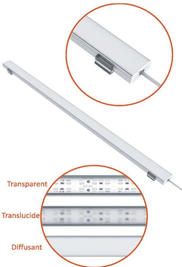
Luminaire basse tension à LED ultra-plats et à haute efficacité (100 lm/W). Longueurs de 25 cm à 2 m et puissances de 6 à 48 W. Corps en profilé aluminium satiné ultra-fin. Fixation facile par clips transparents à visser. Existe en version 24DC (alimenté sur secteur via contrôleur dédié) et 12DC pour alimentation sur batteries. Raccordement sur câble.
